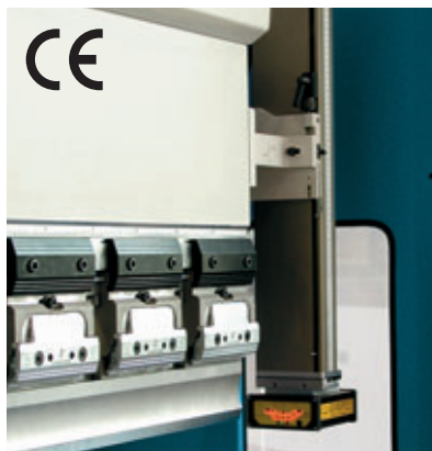
Kollisionsschutzsystem Système anticollision accidentelle
