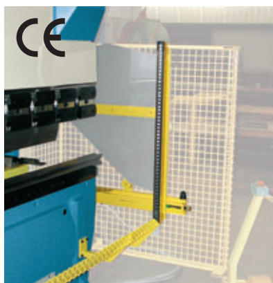
Beispiel des abgesicherten Bereichs während des Absenkens Exemple de zone protégée pendant la descente
