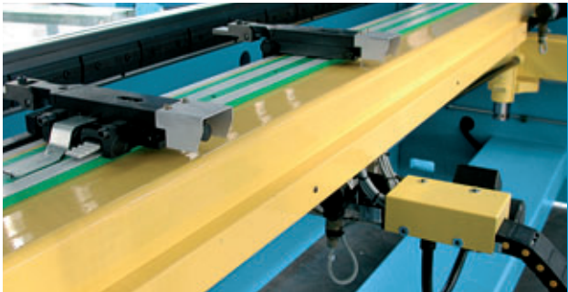
Hinteranschlag Mod. RPL mit 4 Achsen (X R Z1 Z2) mit CNC-gesteuerter Verstellung der Anschlagfinger.
