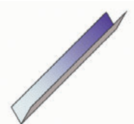
Ergebnis durch die bombierung Résultat avec bombement
