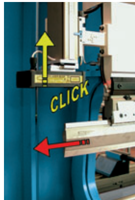
Schnellausschlusssystem der Vorrichtung Système rapide d'exclusion du dispositif
